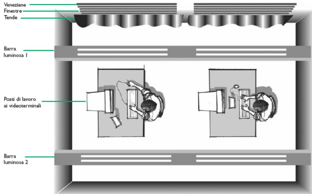
**Ubicazione dei posti di lavoro al videoterminale e disposizione dell'illuminazione nei locali dotati di finestre**
